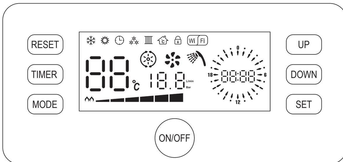
Панель позволяет управлять котлом, контролировать ошибки, управлять работой внешнего трёхходового клапана и термостата.
